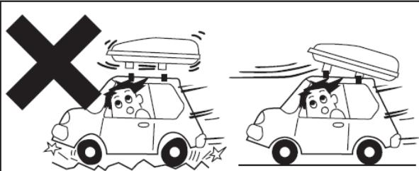
При движении с размещенным в боксе грузом соблюдайте скоростной режим, установленный в данной местности. Снизьте скорость движения при сильном ветре и плохом состоянии дороги.
