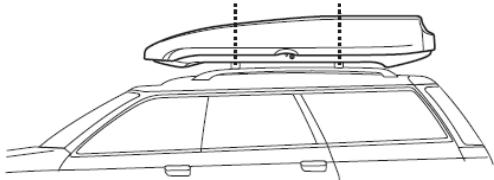
Максимальная нагрузка составляет 50 кг. Убедитесь в том, что груз размещен равномерно по всей площади автомобильного бокса. Запрещается размещать груз, вес которого превышает 10 кг, в передней части бокса.
