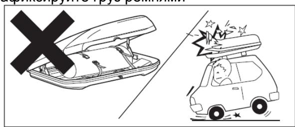
Убедитесь в том, что груз, находящийся в боксе, надежно зафиксирован ремнями. В противном случае груз и бокс могут быть повреждены, или груз может выпасть из бокса при резком торможении.
