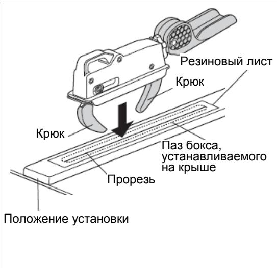
**1** Просуньте крюки системы крепления с функцией запоминания выбранного расстояния внутрь резинового листа, устанавливаемого на крыше. Убедитесь в том, что дуга базового крепления зафиксирована между крюками.
