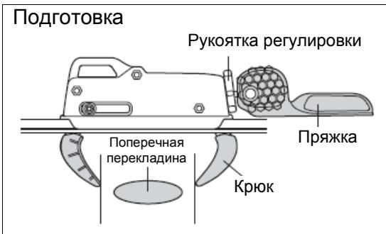
Увеличьте расстояние между крюками при помощи рукоятки регулировки, чтобы вставить между ними поперечную перекладину (поперечина) базового крепления.
