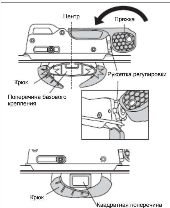
**2** Застегните пряжку. Поверните рукоятку регулировки по указанной стрелке (или по часовой стрелке), чтобы выровнять по центру оба крюка и базовое крепление.
