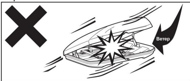
Открывание и закрывание бокса при сильных порывах ветра или сильном ветре может вызвать его повреждение или блокирование частей тела в боксе, приводящее к травме.
