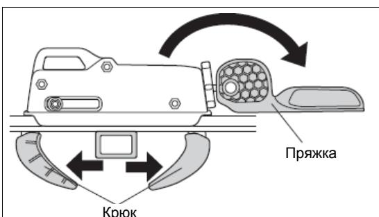
**3** Поднимите пряжку. Два раза поверните рукоятку регулировки по указанной стрелке (или по часовой стрелке). Застегните пряжку и отрегулируйте натяжение крюков.
