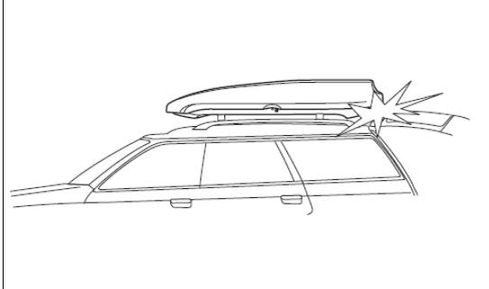
Если у вашего автомобиля имеется багажник (задняя дверь). Перед установкой автомобильного бокса на крышу полностью откройте багажник и убедитесь, что он не касается бокса. Если багажник касается бокса, измените положение бокса или базового крепления.
