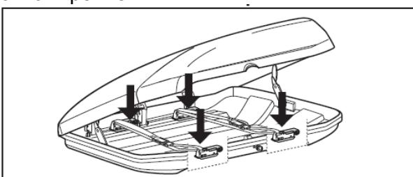
Перед движением проверьте 4 точки крепления на наличие незатянутых болтов/креплений. Затяните все обнаруженные незатянутые болты/крепления.
