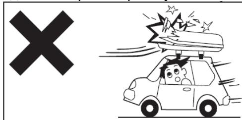
Надежно закройте крышку бокса. В противном случае она может открыться во время движения транспортного средства и повредиться и/или слететь с крыши из-за напора ветра.
