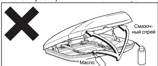
Использование любого вида смазочного спрея, масла, смазки, растворителя или дезинфицирующего средства может вызвать ухудшение свойств материалов, из которых изготовлен бокс, что приведет к повреждению и отсоединению бокса. Не наносите масло на ключи и шарнирные секции.
